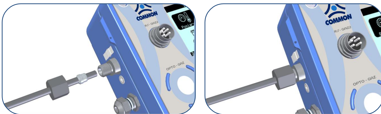
Rysunek 5.11 Podłączenie pomiaru ciśnienia od strony przelicznika
